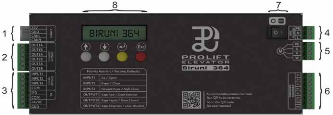
Şekil 1 Kapı Kartı İç Yapısı
