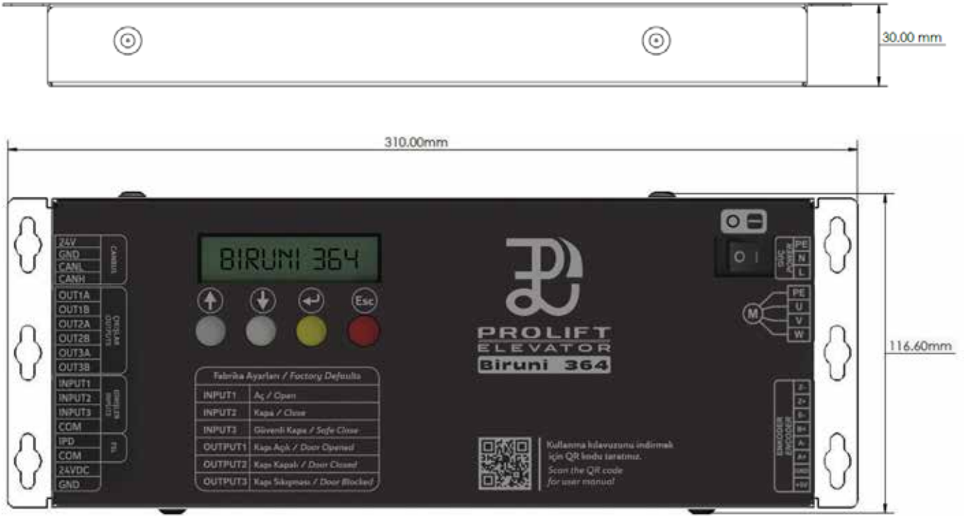
Şekil 13 BIRUNI 364 Uzunluk x Genişlik x Yükseklik Ölçüleri
